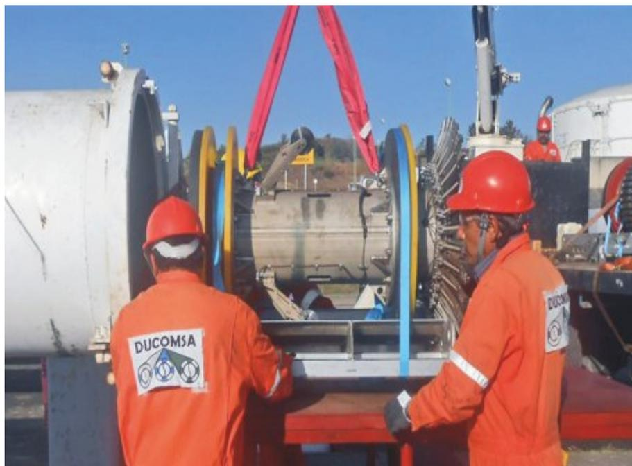
**Foto 6.** Diablo instrumentado para inspeccionar un ducto. Fuente: Ducomsa
